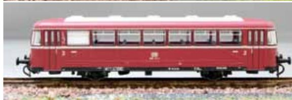
Der Beiwagen ist zur Einstellung zwischen VT und VS des Epoche IV-Modells konfiguriert. Die dafür deaktivierten Scheinwerfer und Schlusslichter können für andere Anwendungen durch Schließen von Lötbrücken bzw. entsprechende CV-Programmierung aktiviert werden.
