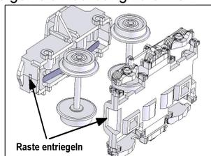
Weiterhin sind die Anschlussdrähte der Schleifer (grau) umzulöten bzw. zu entfernen:
